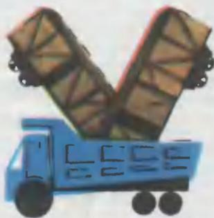
120 тонн и более для горнодобывающей промышленности. И вот один из этого семейства — 100-тонный — готов. В его кузов входит груз двух железнодорожных вагонов.
